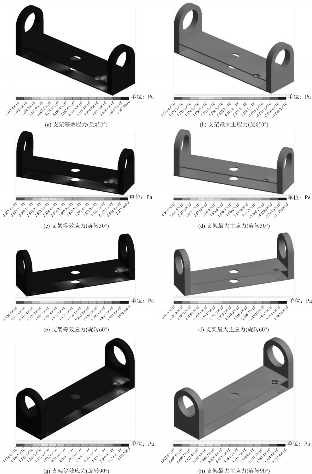
图6 支架的应力云图
