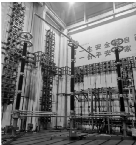
图9 隔离开关寿命试验
